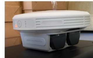
充電開始する（写真）が、 その後、LED点滅止まり充電OFFする
