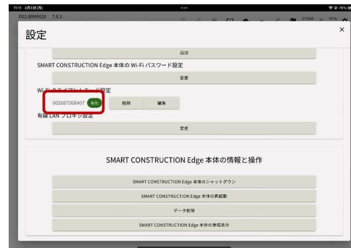
この状態でWiFi Dongleを挿すとAP接続時にLEDが点灯し、以降正常にAPと接続された状態でネットワークにアクセスするとLEDが点滅します
