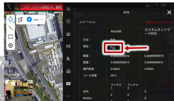
RTKアイコンタップしてメニューを表示し、RTK測位をONにする
