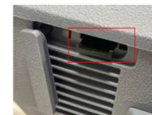
機体側面：SIMカードトレイの取り出し
